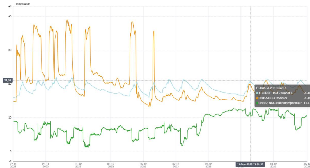
Figuur 3; De radiator schakelde in bij een buitentemperatuur < 10 graden, op verzoek aangepast vanaf 07-12 naar een ander setpoint om de warmteopslag van PCM beter te benutten.
